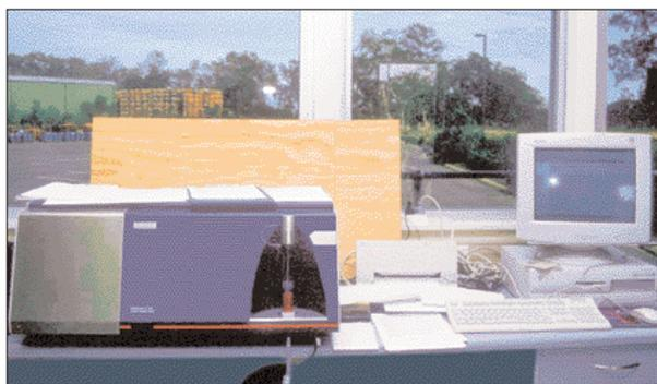
La mise au point du procédé a été réalisée avec un interféromètre utilisant la spectrophotométrie infrarouge à transformée de Fourier : le Winescan FT 120 de Foss. Il permet de scanner la
